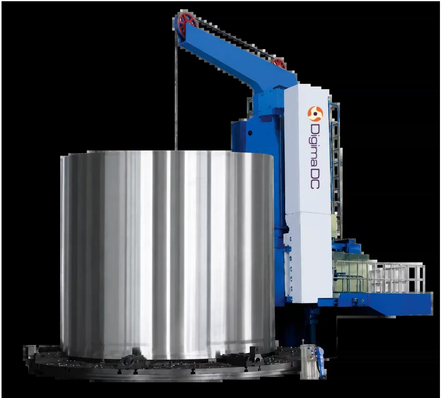
Zdjęcie główne modelu DTL-160S-CNC Tokarka pionowa CNC
