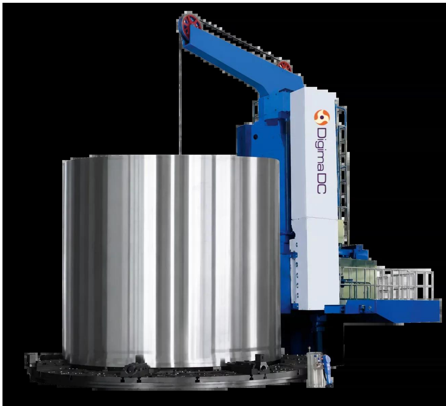
Zdjęcie główne modelu DTL-100S-CNC Tokarka pionowa CNC
