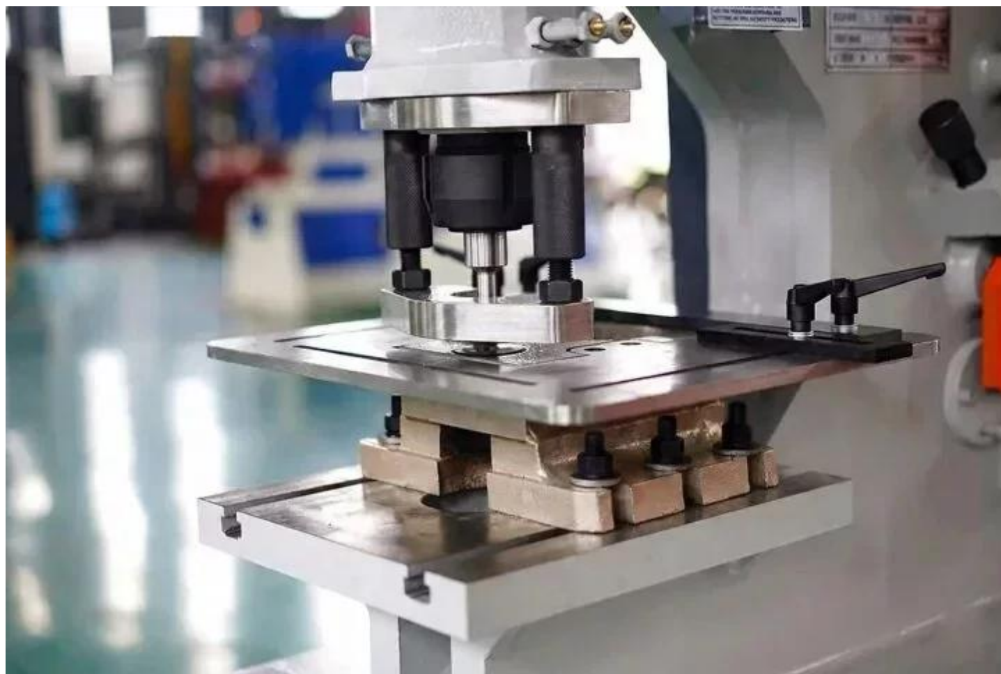
Poste de poinçonnage — force de 160 tonnes
