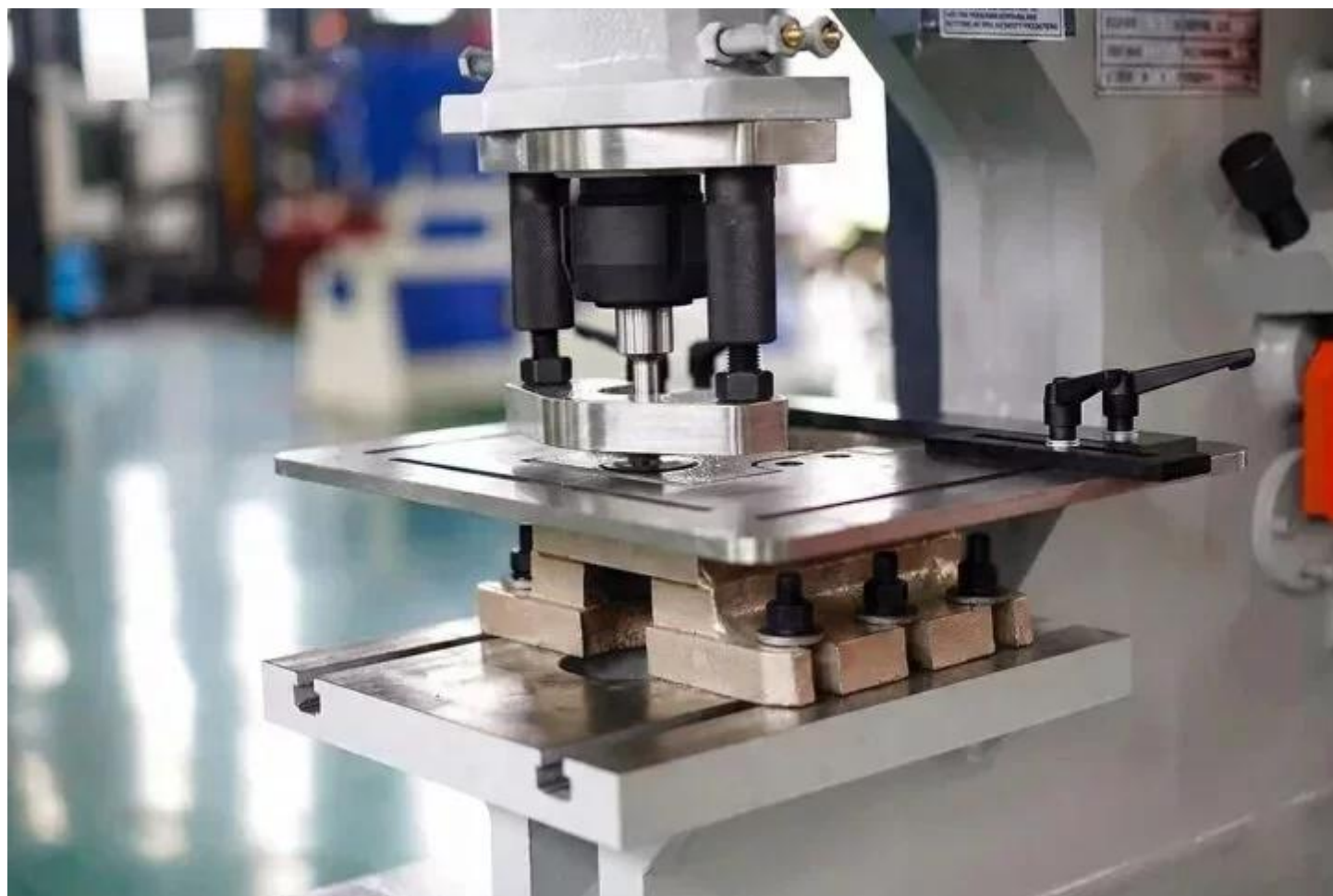
Poste de poinçonnage — force de 90 tonnes
