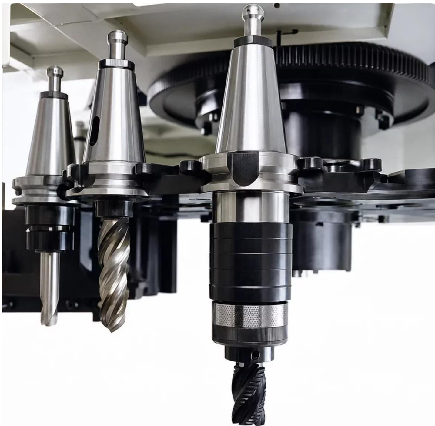
Changeur automatique d'outils ATC
