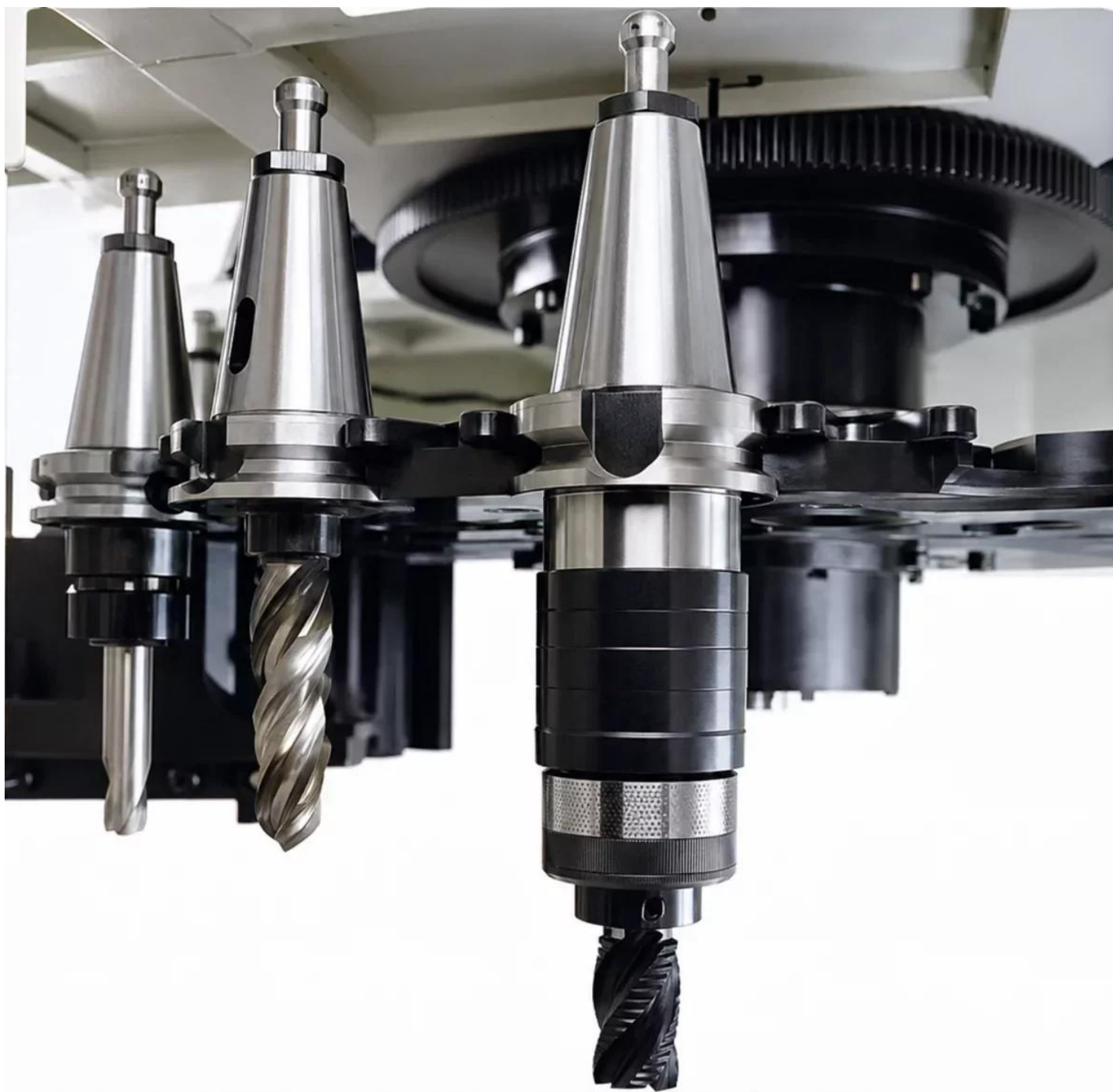
Changeur automatique d'outils ATC
