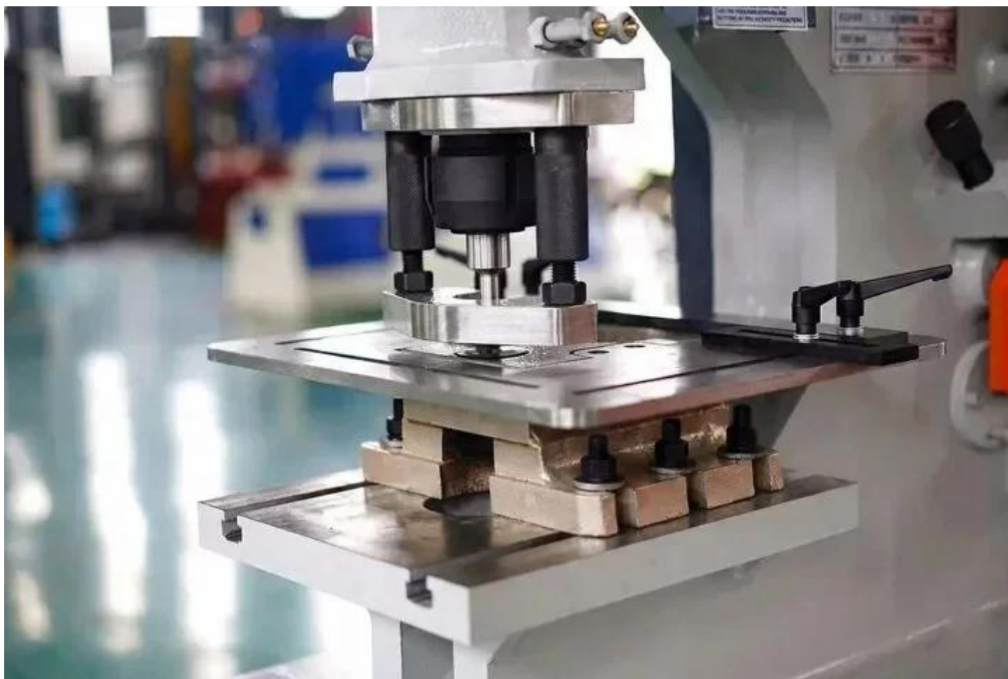
Stanowisko wykrawania otworów – nacisk 200 ton
