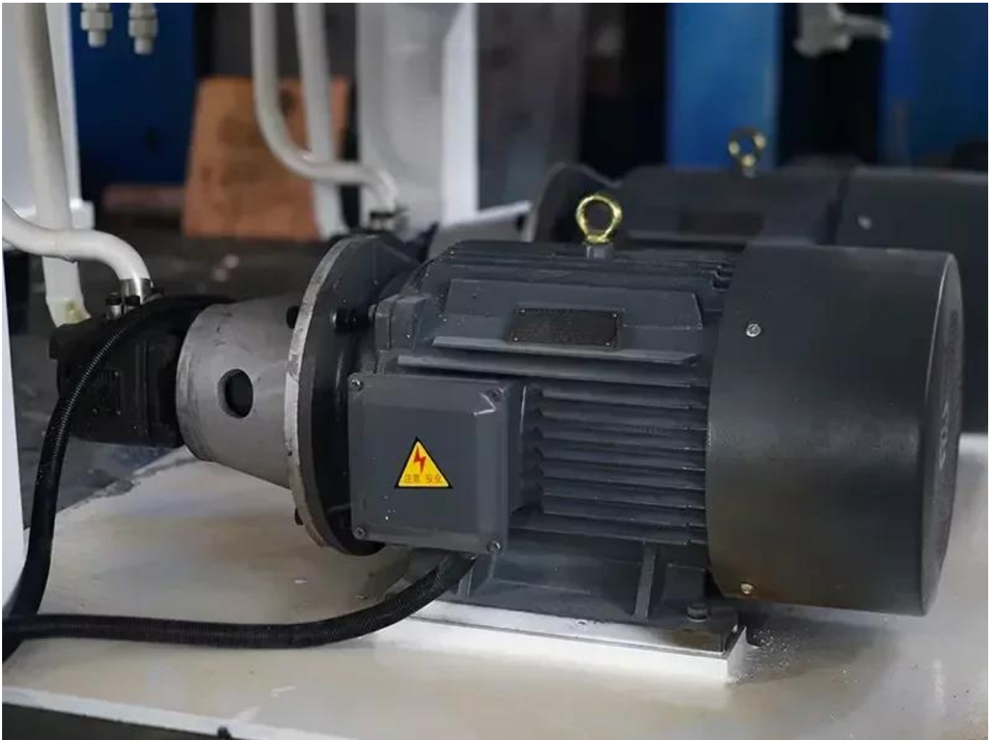
Hauptmotor mit 5.5 kW Leistung
