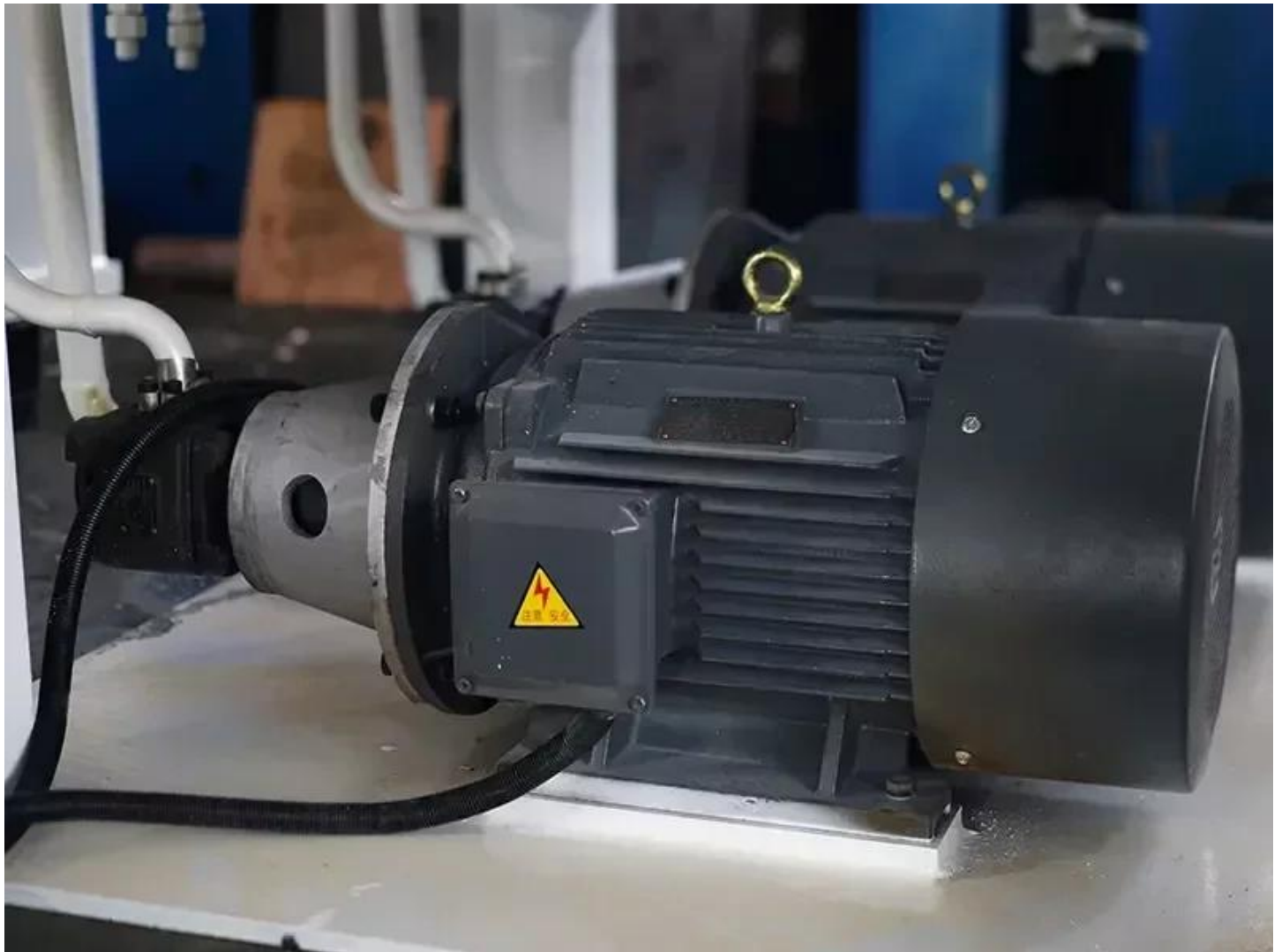
Hauptmotor mit 15 kW Leistung
