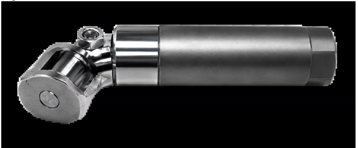
Optionaler Dorn Empfohlen für kleine Biegeradien und dünnere Wandstärken. Hilft, die Verformung des Rohrquerschnitts zu begrenzen.
